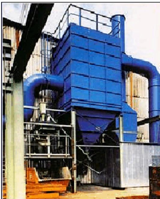
**Abbildung 4.28: Foto einer industriellen Schlauchfilterkammer**
